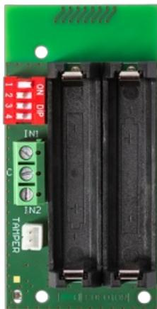
Le JA-162M est un module sans fil du système JABLOTRON, doté de deux entrées universelles indépendantes et de la possibilité de connecter un contact de sabotage.
