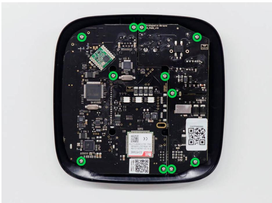
6. Retirez soigneusement les deux cartes, en les maintenant dans le même plan et sans les déconnecter. Il y a un connecteur entre les cartes : ne le coupez pas.
