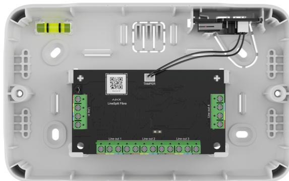
5. Installez le couvercle sur le boîtier et fixez-le avec les vis jointes.
