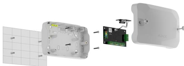
3. Fixez le dispositif dans le boîtier. Acheminez les câbles et faites-les passer dans les trous préparés à l'avance. Fixez les câbles avec des serre-câbles à
