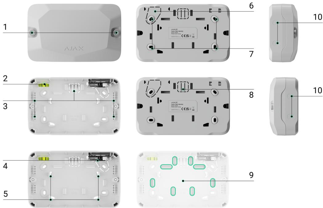
1. Befestigungsschrauben zur Fixierung des Gehäusedeckels. Lösbar mit dem mitgelieferten Inbusschlüssel (Ø 4 mm).
