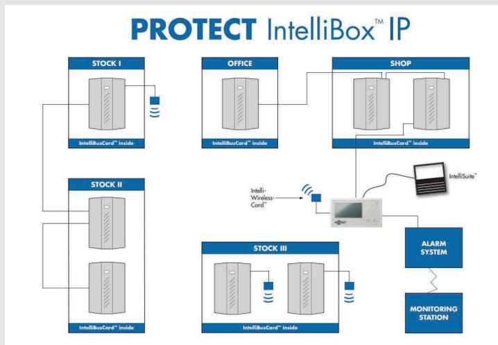
Voici 3 exemples de mise en oeuvre et de connexion de plusieurs générateurs de brouillard en utilisant le système intelligent IntelliBox IP.
