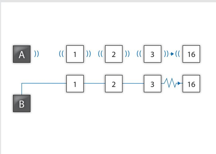
Chaque IntelliBox IP peut contrôler jusqu'à 16 générateurs de brouillard. Selon le niveau de sécurité nécessaire, vous pouvez choisir entre une connexion sans fil (A), une connexion par fil/paire torsadée (B) ou une combinaison des deux.
